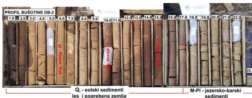
Slika 3. Fotografija jezgra dopunske bušotine DB-2
